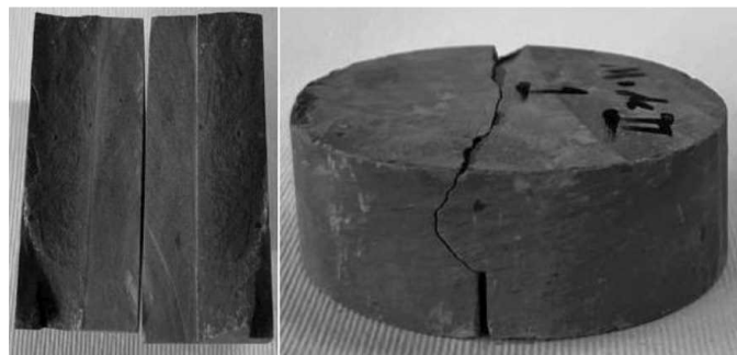
شکل (۱۶): شکست سنگ مخزن تحت مود خالص II، راستای رشد ترک و سطوح شکست نمونه ENDB
