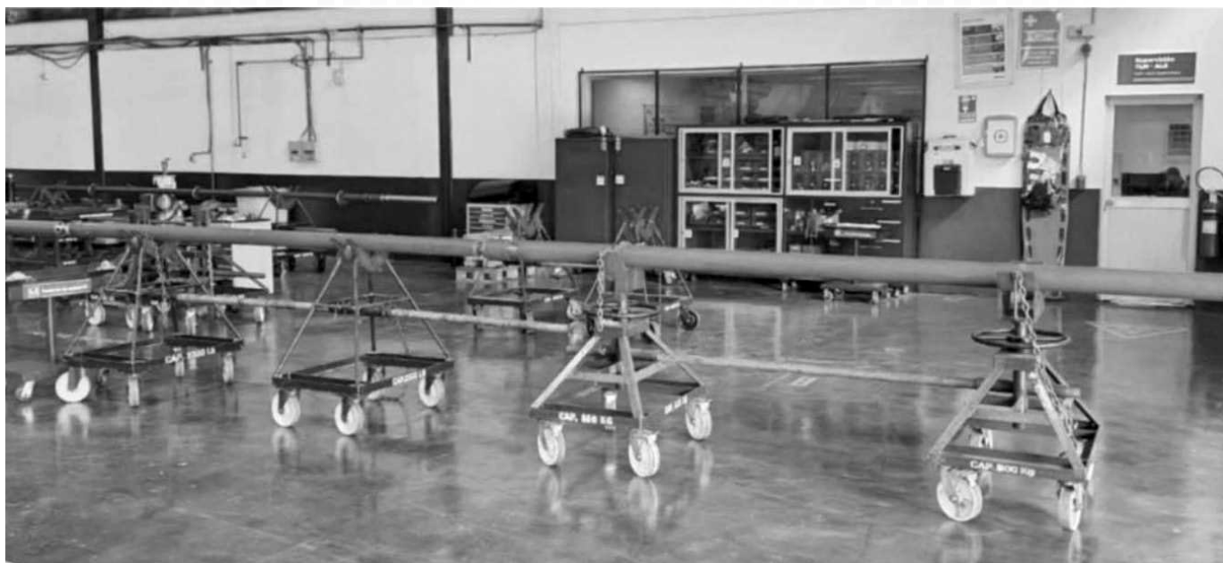
شکل ۴ یک سیستم کامل UHS ESP سرهم شده در کارخانه در حال انجام تست
