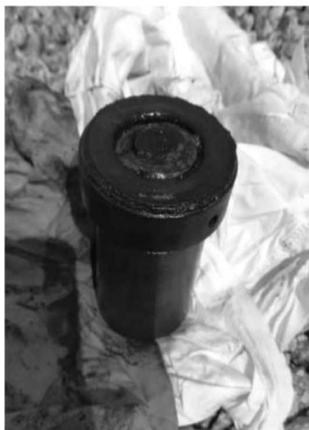
شکل ۵ شرایط یکی از چاه‌ها از لحاظ تولید شن و وجود Scale
