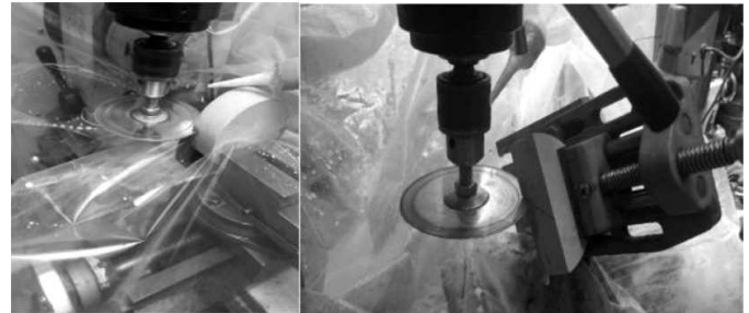
شکل (۴): نمایی از ایجاد ترک به کمک دستگاه تراش
