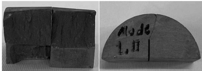
شکل (۱۱): شکست سنگ مخزن تحت مود مرکب I/II، راستای رشد ترک و سطوح شکست نمونه SCB
