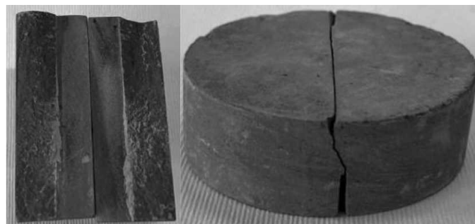
شکل (۱۵): شکست سنگ مخزن تحت مود مرکب I/II، راستای رشد ترک و سطوح شکست نمونه ENDB
