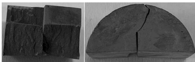
شکل (۱۲): شکست سنگ مخزن تحت مود خالص II، راستای رشد ترک و سطوح شکست نمونه SCB
